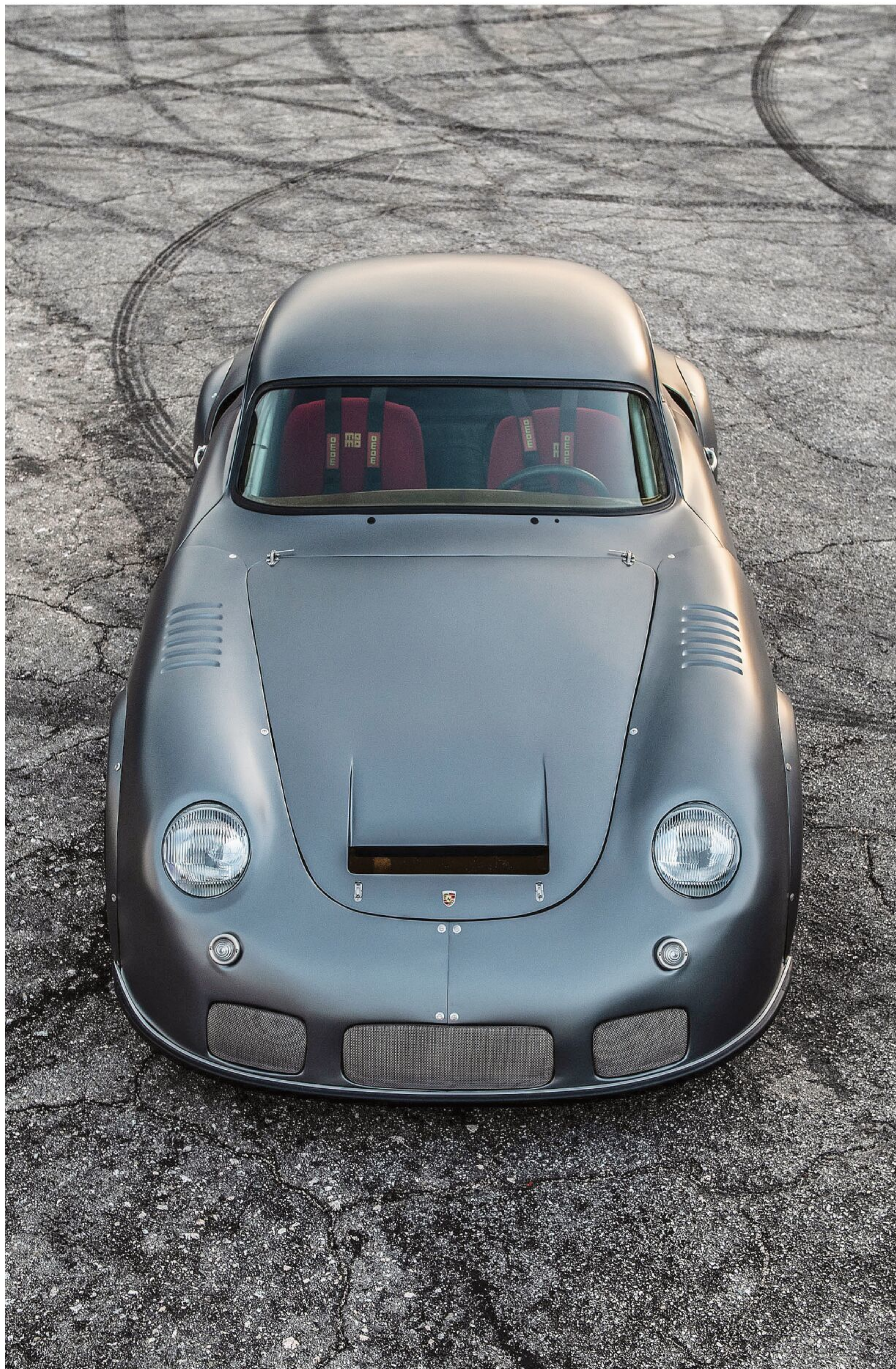
Das Dach ist noch original, die Scheinwerfer sagen 356. Der Rest ist ein Maßanzug aus leichtem Aluminium auf einer Bodengruppe aus den Neunzigern.
